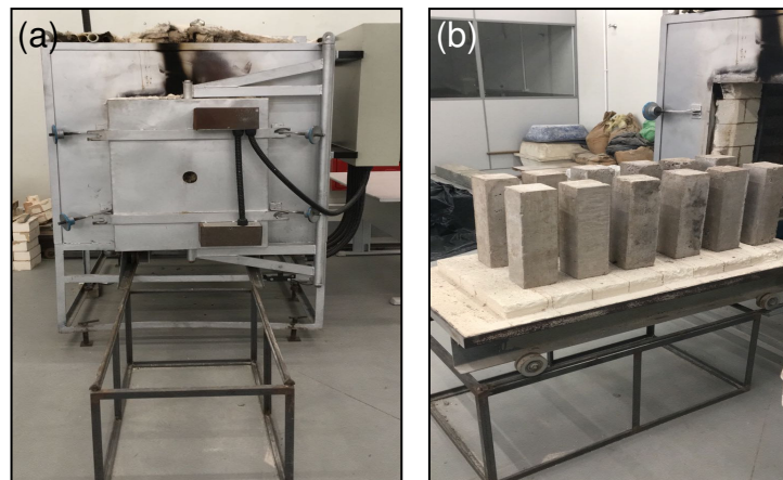
Figura 4 - Forno Mufla: fechado (a) e posicionamento das amostras na mufla (b).
