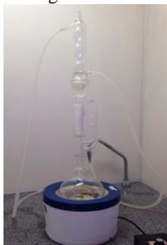
Figura 26 -Extração de Agente Deslizante por Clorofórmio -
