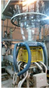
Figura 24 - Extrusão dos Filmes de Referências Industriais R1 e R2
