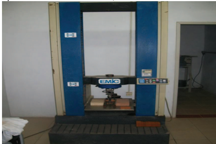
Figura 23 – Máquina universal de ensaios, EMIC. SindiCer - Morro da Fumaça/SC.
