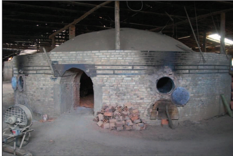
Figura 14 - Vista frontal de forno intermitente tipo “paulistinha”, Morro da Fumaça/SC.
