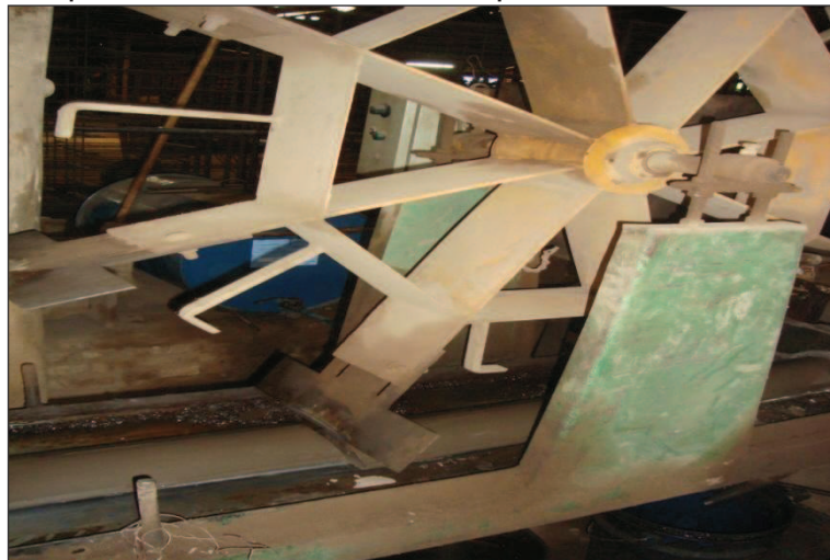
Figura 9 - Vista parcial do sistema de corte para telhas, Morro da Fumaça/SC.
