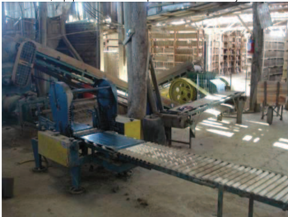
Figura 8: Cortador, equipamento utilizado para realizar o corte tijolos.
