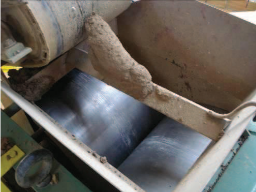
Figura 6: Laminador, equipamento utilizado para uma melhor compactação e homogeneização da massa de argila.
