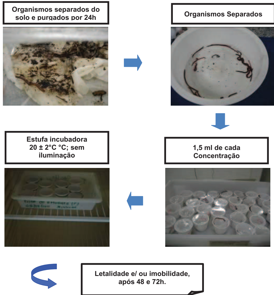
Figura 24: Esquema do Ensaio de Toxicidade Aguda com Oligoqueto Eisenia foetida em papel de contato, realizados com ambas as amostras com efluente (NF) (F) e respectivo controle negativo.
