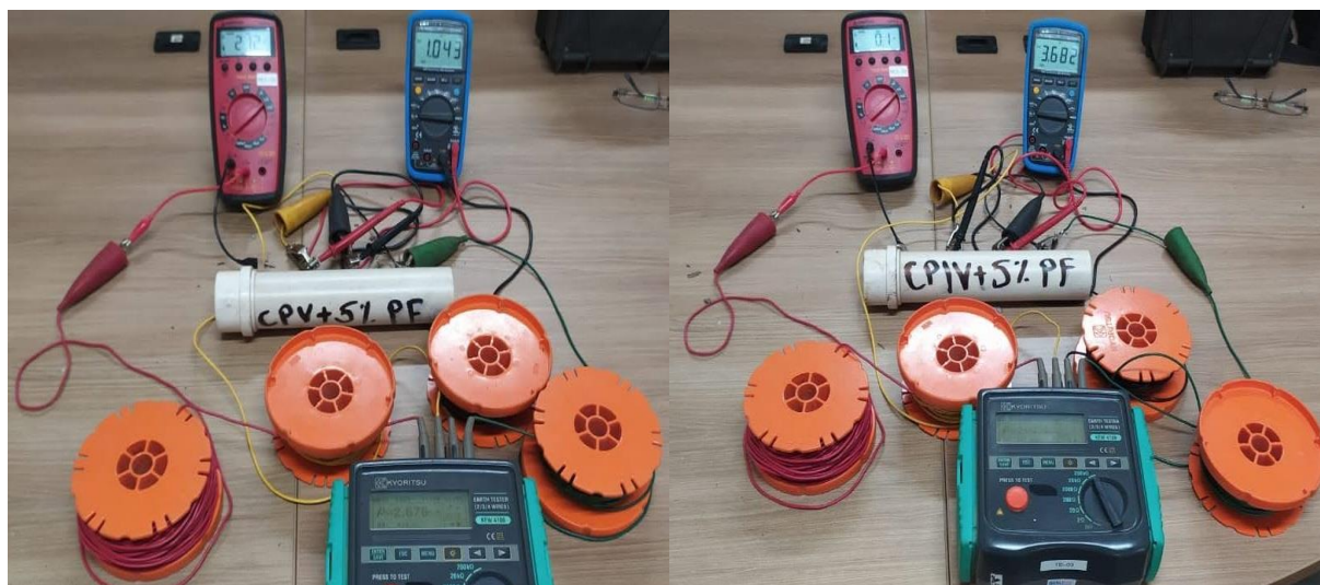
Figura 5. Execução do ensaio de resistência elétrica das pastas
