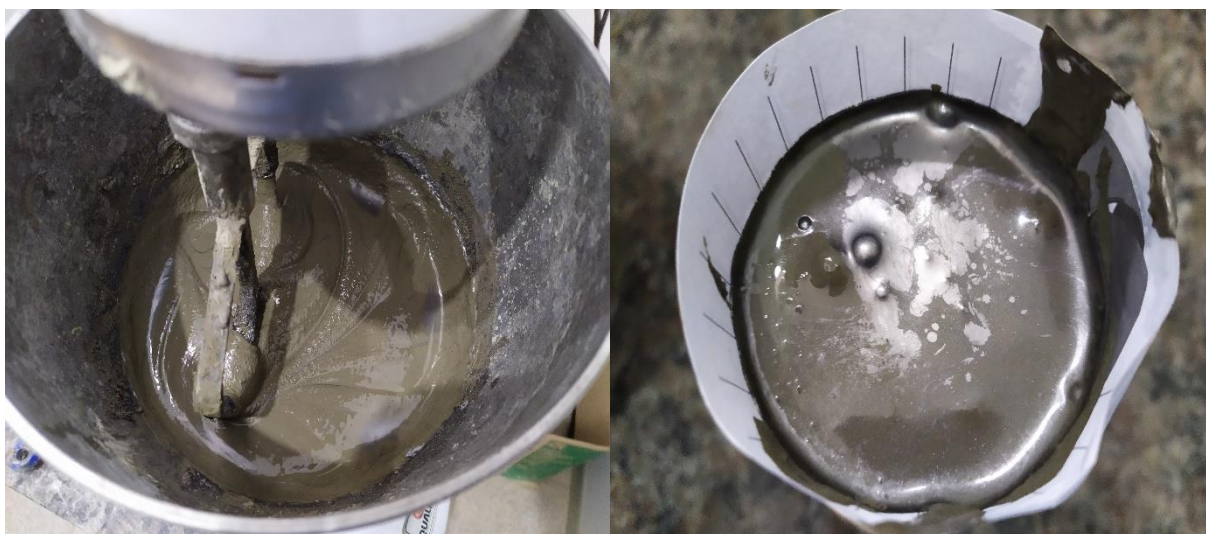
Figura 11. Homogeneização da pasta de cimento com adição de pó de ferro
